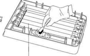
Elektrik deşarj teli
